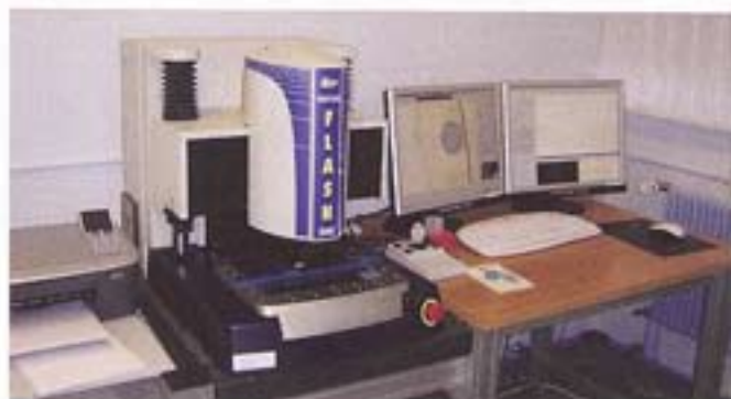
Kontroll-Arbeitsplatz mit automatischem Messsystem.
