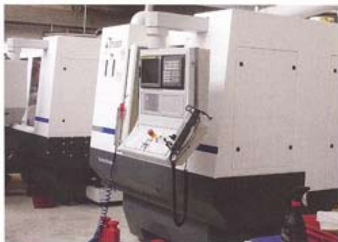
Diese Studer S21 mit CNC-Steuerung in der Abteilung Schleifen bei Tesa S.A. in Renens sorgen für eine äusserst prozesssichere Bearbeitung.
