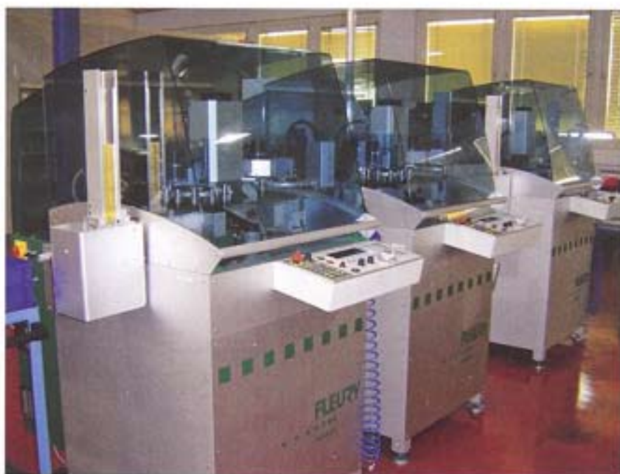
Die im Beitrag beschriebene Transferstrasse mit den drei Fräsmaschinen.
