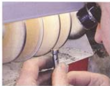
Fingerspitzengefühl ist hier gefragt: Manuelles Entgraten filigraner Uhrenteile.
