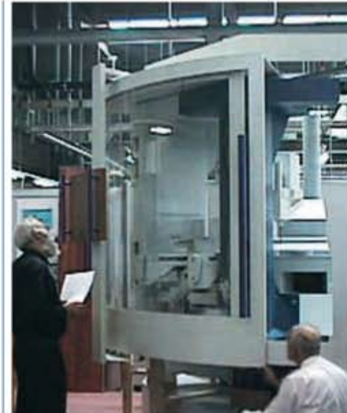
Ergonomie sicher stellen, Spänefluss prüfen, Werkzeugwechsel proben, am echten Teilmodell M, 1 : 1. (Bild: Mikron Agno)
