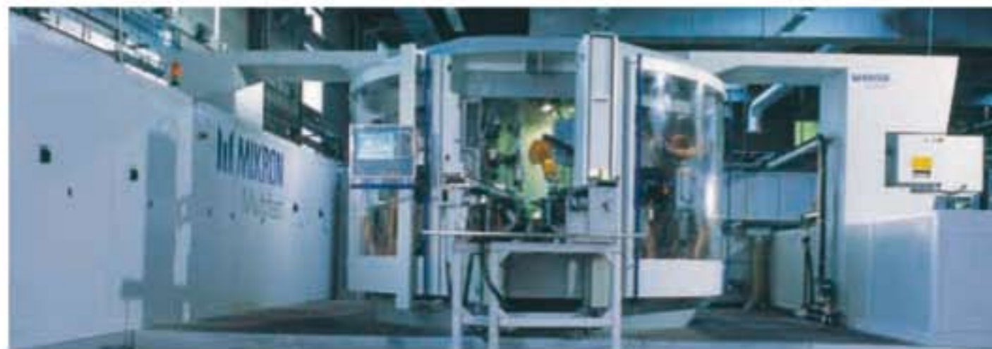
Im 6-Sekunden Takt vollzieht die Mikron Multifast™ Rundtakt Werkzeugmaschine (hier die Maschinenrückseite mit Befestigung) bis zu 30 hochpräzise Bearbeitungsschritte (Stückgrösse 100/100/100 mm) vollautomatisch. (Bilder: Mikron Agno)
