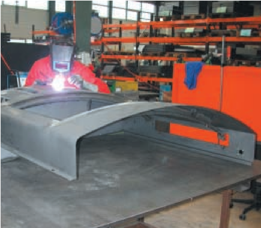
Die Karosserie wird bei Mecaplex gefertigt. Trotz modernster Roboterschweis- und Laserschneidanlagen sowie numerisch gesteuerter Blechbiegemaschinen müssen noch viele Schweißnähte manuell geschweisst werden.
